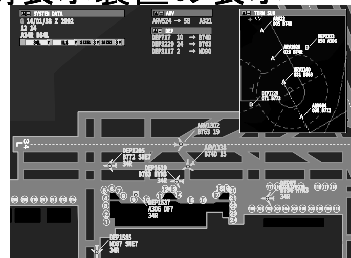
新タワー表示装置
